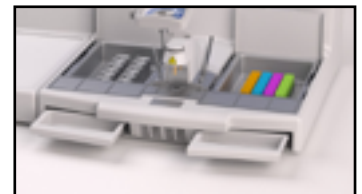
Herausnehmbaren Schalen zur Aufbewahrung von Kassetten und Ausgießformen. Überflüssiges Paraffin sammelt sich in 2 Schubladen
